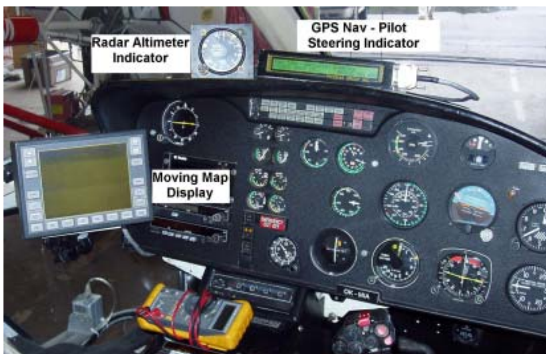
Obr. Instalace navigačního systému v helikoptěře
