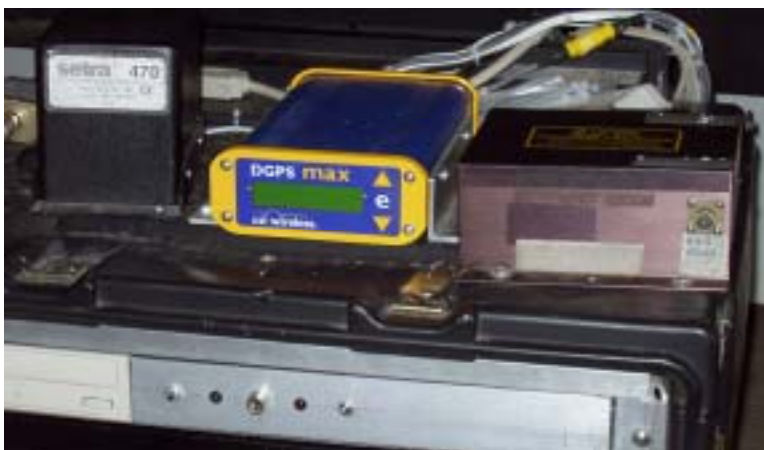
Obr. Navigační přijímací systém OMNISTAR DGPS-Max a model Setra 470 pro barometrická výšková měření
