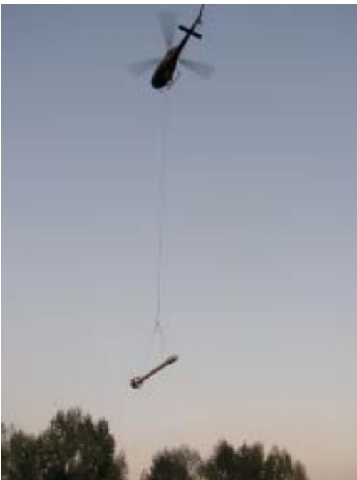
Obr. Vlečení systému 30 m pod helikoptérou
