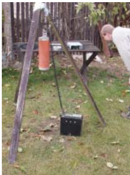
Obr. Gamaspektrometr - stabilní stanice
