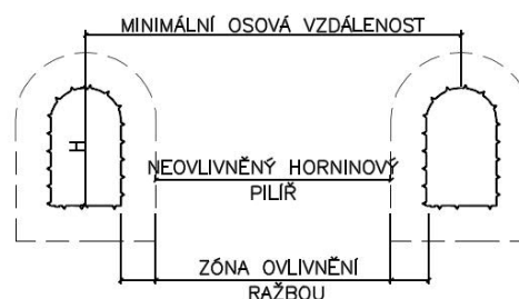
Obr. 53 – Princip stanovení minimální vzdálenosti mezi zav. chodbami / ukládacími vrty
