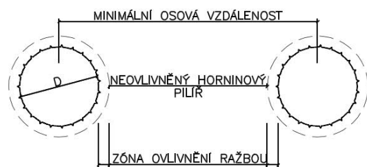
Obr. 53 – Princip stanovení minimální vzdálenosti mezi zav. chodbami / ukládacími vrty
