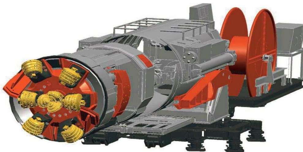
Obrázek 16: Schéma velkoprofilového vrtného stroje (Box Hole Borer)
