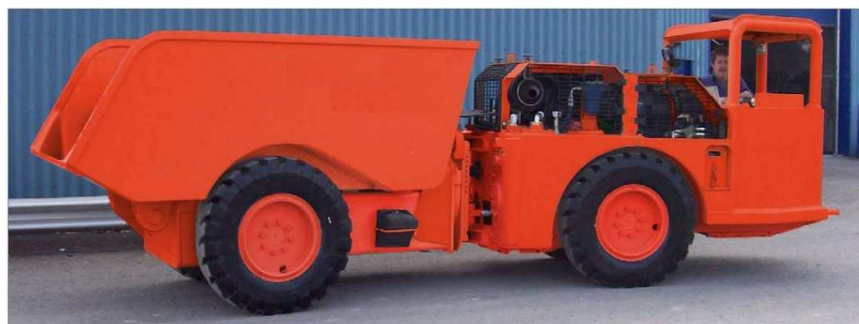
Obrázek 8: Menší dumper s korbou o nosnosti 7 t.
