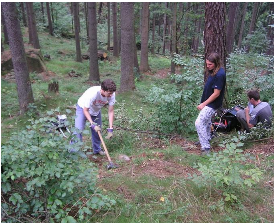
Obr. 3.1-6. Měření seismickou metodou. Pomocník vlevo budí seismické rozruchy úderem kladiva. V pozadí vpravo operátor se seismickou aparaturou.
