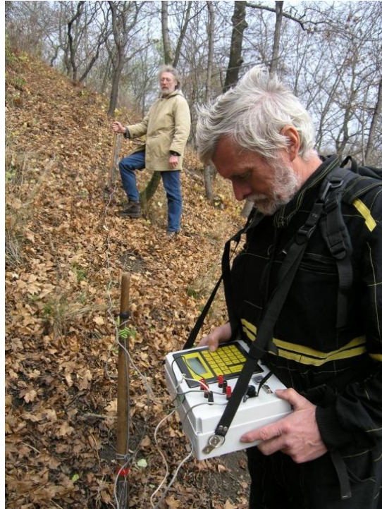
Obr. 3.1-5. Měření metodou SOP. V popředí záběr na operátora s potenciometrem a jednou z potenčních elektrod. V pozadí pomocník s jednou z proudových elektrod.
