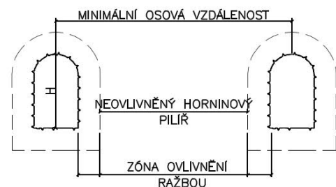
Obr. 60 – Princip stanovení minimální vzdálenosti mezi zavážecími chodbami / ukládacími vrty
