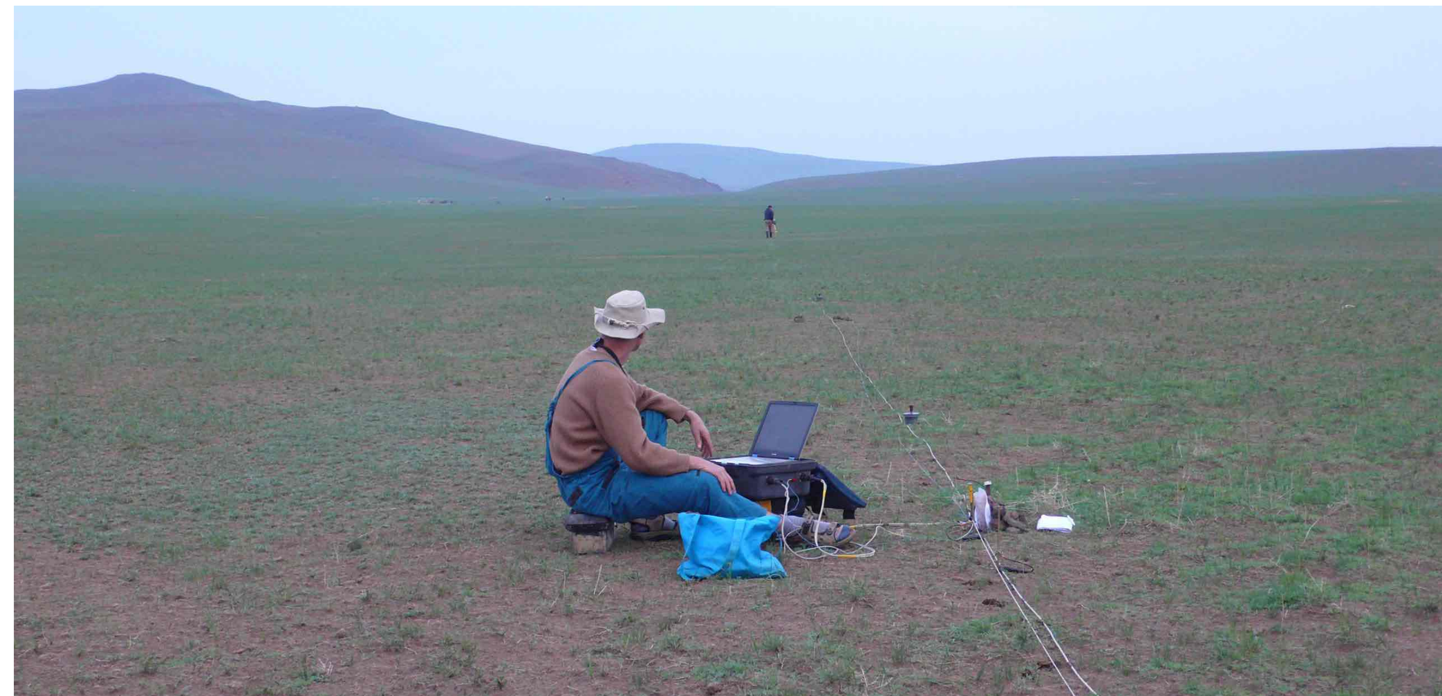
Měření geoelektrické odporové metody
