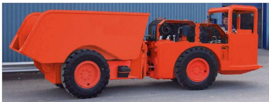
Obrázek 8: Menší dumper s korbou o nosnosti 7 t.
