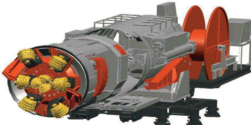
Obrázek 16: Schéma velkoprofilového vrtného stroje (Box Hole Borer)
