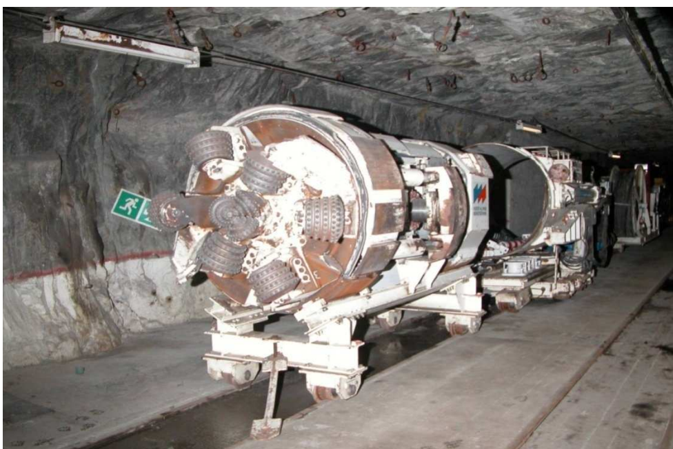
Obrázek 32: Velkoprofilové vrtací zařízení v remíze. Ilustrační foto.
