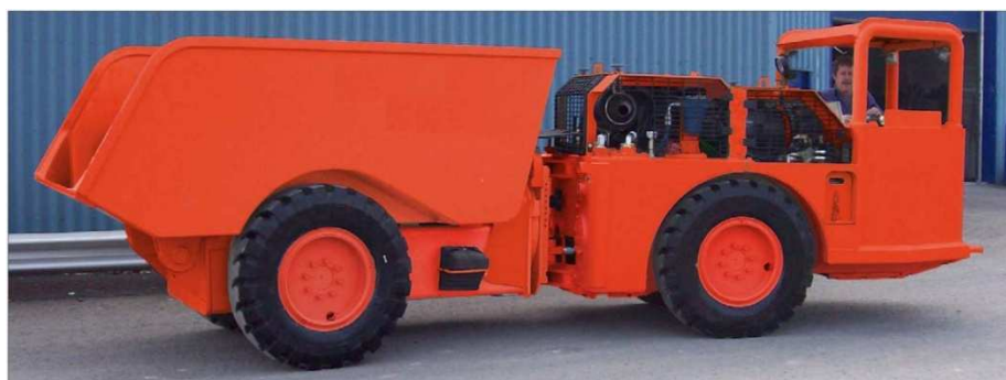
Obrázek 8: Menší dumper s korbou o nosnosti 7 t.
