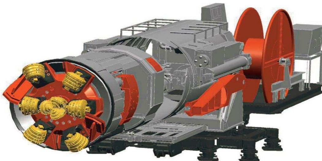
Obrázek 16: Schéma velkoprofilového vrtného stroje (Box Hole Borer)
