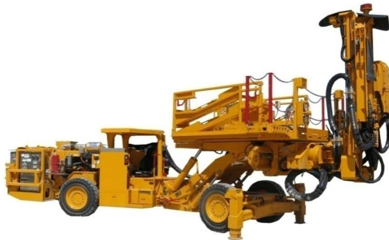
Obrázek 10: Plošina na osazování kotev a ocelových sítí
