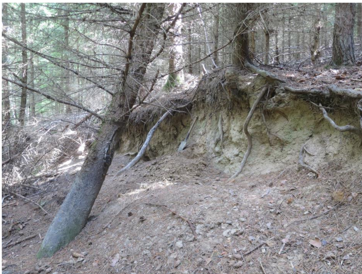
Obr. 24 Odlučná hrana sesuvu v prostředí deluviálních sedimentů a rulového eluvia (192IRV0165)
