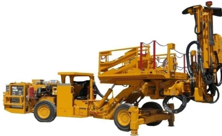
Obrázek 10: Plošina na osazování kotev a ocelových sítí
