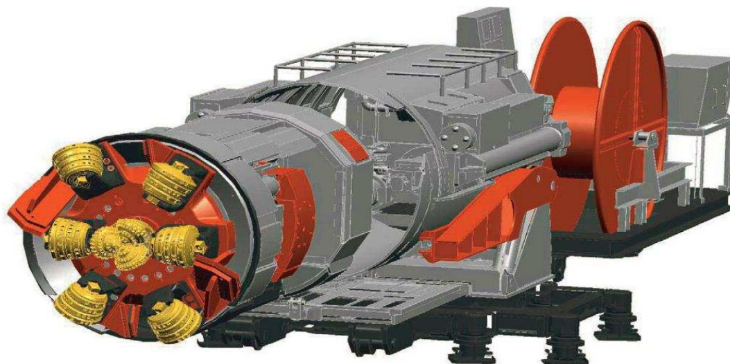
Obrázek 16: Schéma velkoprofilového vrtného stroje (Box Hole Borer)
