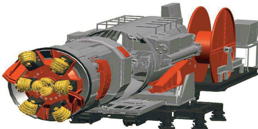
Obrázek 16: Schéma velkoprofilového vrtného stroje (Box Hole Borer)
