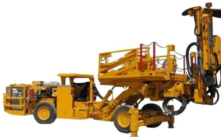
Obrázek 10: Plošina na osazování kotev a ocelových sítí
