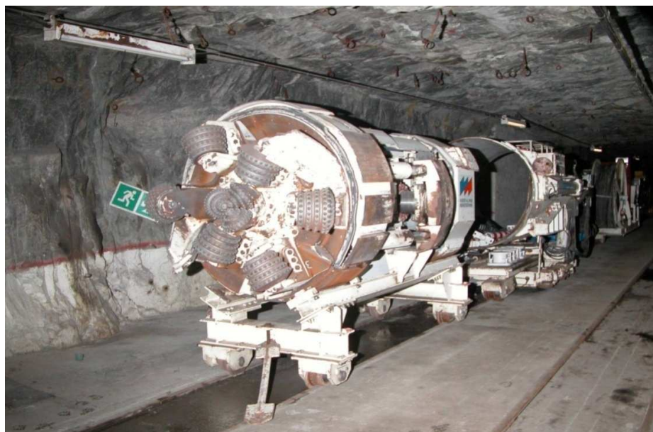
Obrázek 32: Velkoprofilové vrtací zařízení v remíze. Ilustrační foto.
