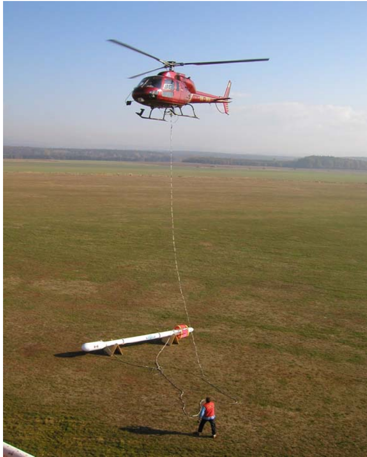
Obr. 3: Helikoptéra s podvěšenou sondou.
