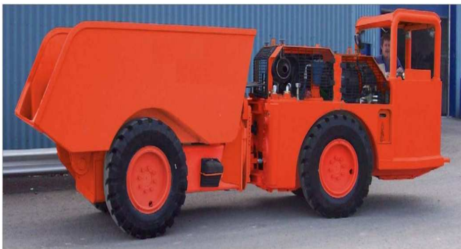
Obrázek 8: Menší dumper s korbou o nosnosti 7 t.
