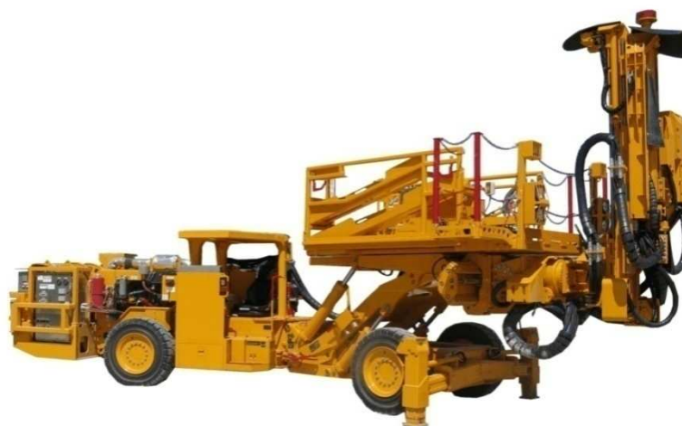
Obrázek 10: Plošina na osazování kotev a ocelových sítí
